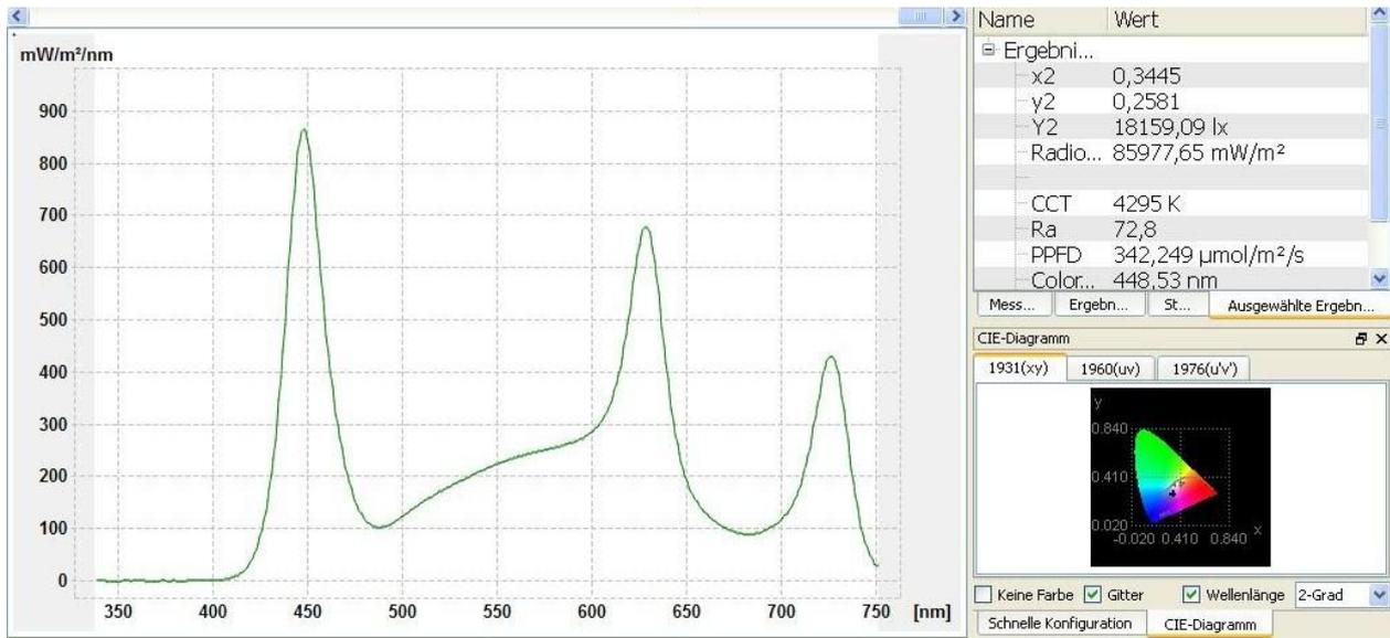
Farbspektrum eines LED Modules mit der Bestückung Rot, Infrarot, Blau und Weiß.
